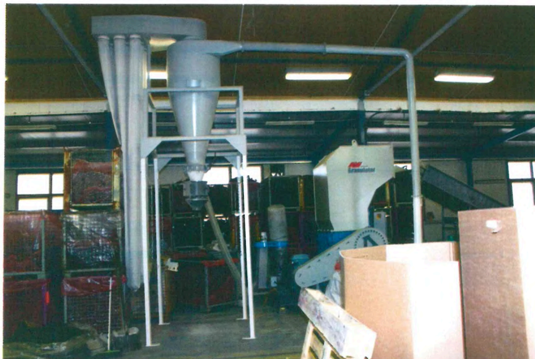
Obrázek č. 6 – Pohled na nožový mlýn s odsáváním a filtrací vzdušiny
